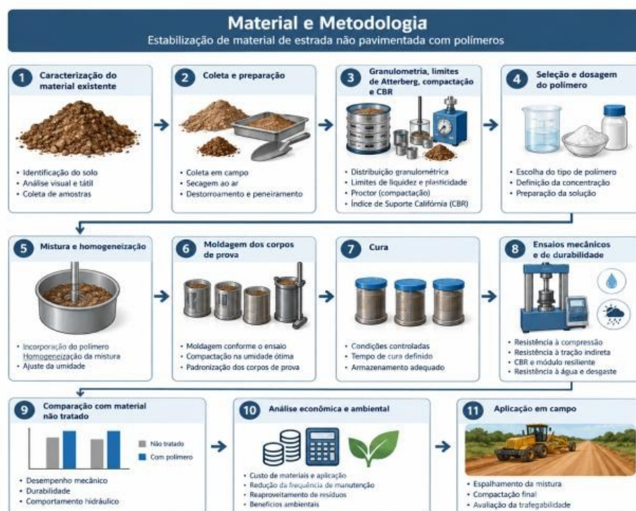
Figura 2 – Estabilização de material de estrada não pavimentada com polímeros
