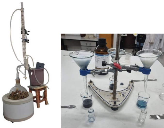
Figura 4 – Hidrodestilação e purificação do óleo essencial das folhas de Croton blanchetianus .
