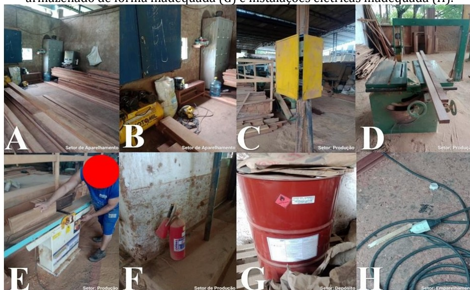
Figura 6 – Visualização dos riscos de acidentes da serraria objeto do presente estudo. Observa-se arranjo físico inadequado (A), arranjo físico inadequado (B), equipamento sem sinalização e sem proteção (C), máquina sem proteção (D), trabalhador sem utilização de EPIs (E), extintor em local inadequado (F), produto químico armazenado de forma inadequada (G) e instalações elétricas inadequada (H).
