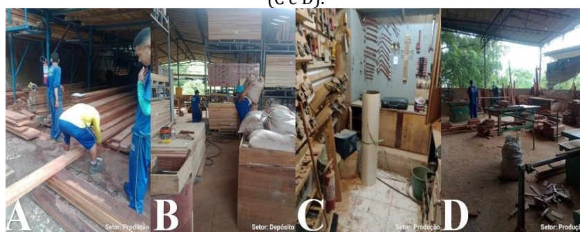
Figura 8 – Visualização dos riscos ergonômicos da serraria objeto do presente estudo. Observa-se trabalhador com postura inadequada (A), levantamento de peso de forma inadequada (B), setores com arranjos inadequados (C e D).
