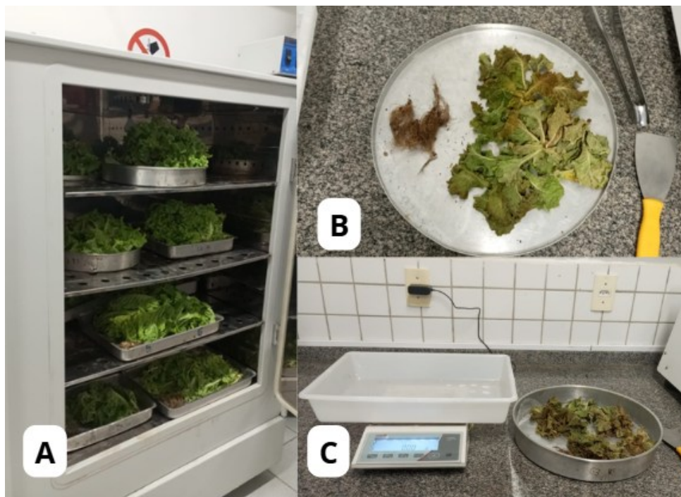
Figura 7 – Materiais utilizados durante o processo de contabilização dos dados experimentais, incluindo estufa e balança digital: A – Alfaces durante etapa de secagem na estufa; B – Visualização da parte aérea e radicular secas; C – Pesagem da parte aérea e radicular.
