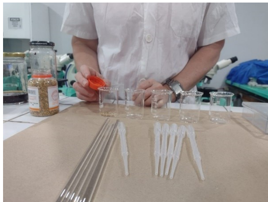
Figura 3- Grãos de pólen apícola desidratado sendo adicionados nos béqueres para serem corados.
