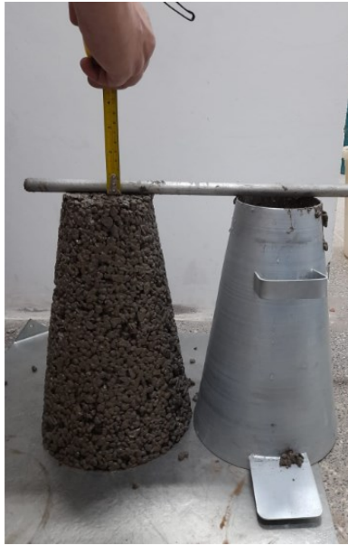
Figura 1. Resultado abatimento do concreto ( Slump Teste ).
