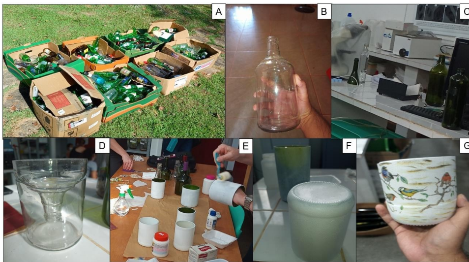
Figura 2. Montagem do porta treco: (A) Vidros e garrafas doadas; (B) Limpeza de vidros; (C) Corte de vidros com máquina de corte de vidraria; (D) Garrafas partidas ao meio e lixadas; (E) Preparo das garrafas com prime; (F) Secagem de tinta prime nas garrafas, (G) Colagem de papel de decoupage e finalização.
