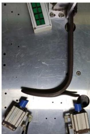
**Figura 8. Ensaio mecânico utilizando o protótipo da máquina de fadiga e o protótipo da bioprótese de pé e tornozelo de madeira laminada e colada com o sensor podobarômetro F-Scan.**
