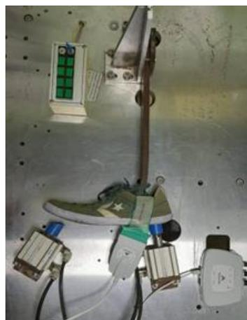
Os dados do Podobarômetro são dispostos primordialmente pelo software conforme as Figuras 8, 9 e 10. É possível ver o local que está recebendo a pressão dos pistões e, além disso, uma escala de cores indicando a proporção da força. Para a comparação com a indicação da norma, gerou-se um gráfico de pressão versus tempo, tanto do teste para a região do antepé quanto do teste para a região do calcanhar. Estes estão dispostos abaixo na Figura 11.
