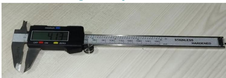
Na figura 1 foi utilizado o instrumento de metrologia tipo paquímetro digital, com precisão de 0,01mm, para medição de dimensões lineares internas, externas, profundidade e espessura da peça modelo utilizada.
