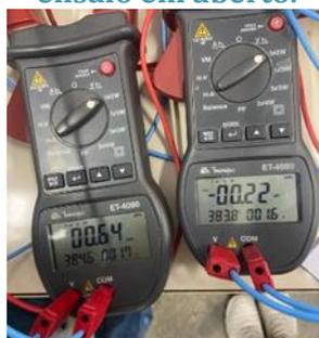
**Figura 3. Ensaio com rotor bloqueado.**
