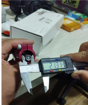
Na figura 7, observa-se a utilização de técnicas dimensionais e metrológicas para o correto entendimento do dimensionamento utilizado no projeto original. Foram retiradas as medidas da prótese de joelho infantil, para garantir a correta modelagem com uso do software Autodesk Inventor(versão 2024). Tais quais como o entendimento dos sistemas mecânicos que possuía o objeto de estudo.
