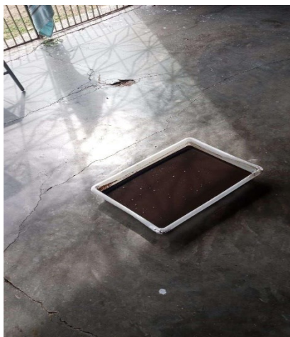
Figura 07 - Amostra de lodo da fossa do A25M em processo de secagem no sol (dia 01)
