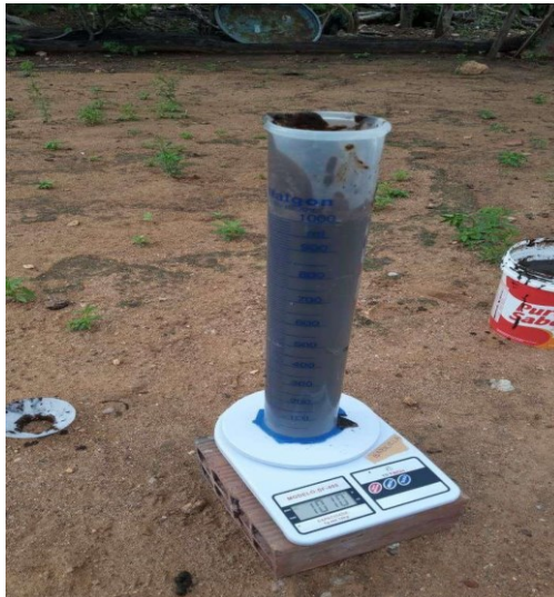
Figura 06 – Pesagem do lodo da fossa do A25M
