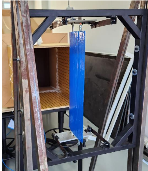
Figura 12 – Fotografia do aparato experimental (aerofólio e túnel de vento)
