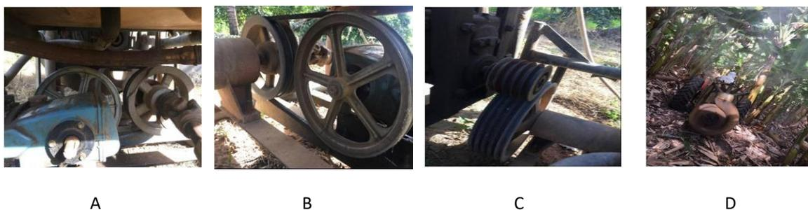
Legenda: 2.A/2.B. Polia de 200 mm sendo acionada pelo cardan a 540 rpm e acionando a polia de 240 mm acoplada à bomba do pulverizador. 2.C. Polia de 320 mm acionando a polia de 100 mm da turbina. 2.D. Turbina acoplada ao pulverizador.
