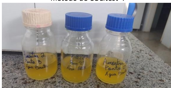
Figura 2 – Análise microbiológica para confirmação de presença de coliformes totais por meio do método de COLItest®.
