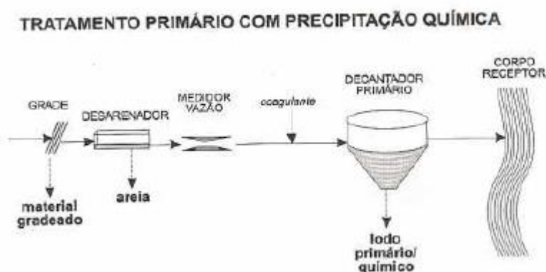
Figura 2 – Esquema de tratamento primário com precipitação química
